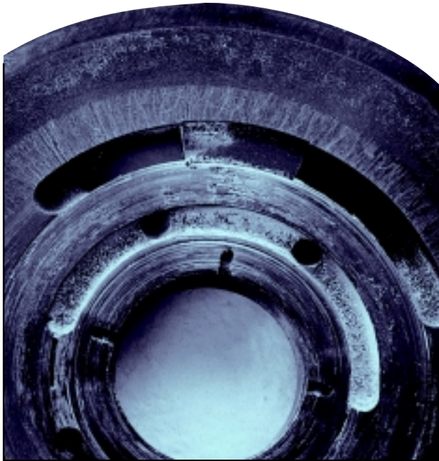
Resultados típicos de desgaste devido à presença de particulados e contaminação de água
